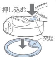
③ カバーをフタから取り外します。フタの受けからカバーの軸部を引き出します。
