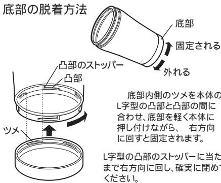
底部内側のツメを本体のL字型の凸部と凸部の間に合わせ、底部を軽く本体に押し付けながら、右方向に回すと固定されます。
