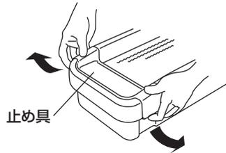
図のように、本体ケースの止め具を片側ずつ外します。
