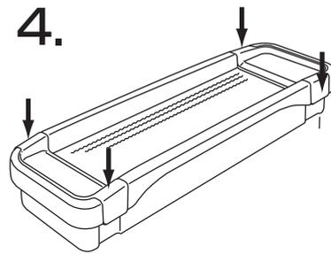
ツメみがきを本体ケースの凸部に押し込みセットし、止め具で固定してください。
