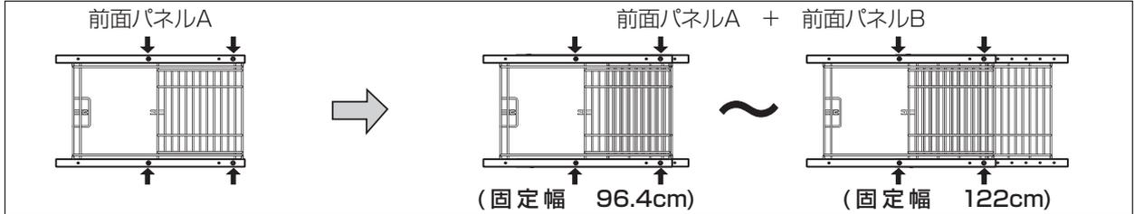
前面パネルBのドア側のワイヤーで入口が狭くなる場合は、以下の手順にしたがってドア側のワイヤーを取り外してください。
