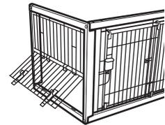
※ 設置場所によっては側面パネルBを固定フレーム側に取付け可能です。
